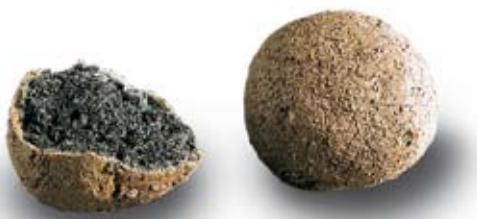
Figura 1a Le argille espanse: il grano di Leca.
